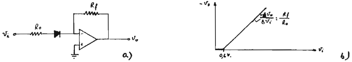
Fig. 32.- Generador de funciones con v_{i, on} = 0,6V .
