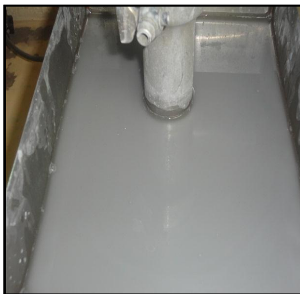
Figura 3.37. Coloración del relave rico en cuarzo, obtenido de la flotación colectiva
