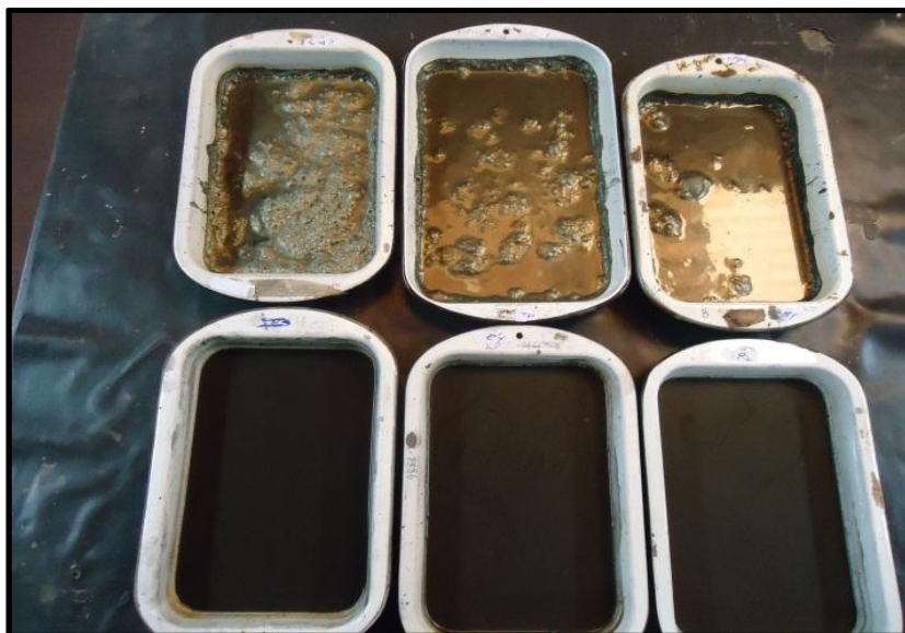
Figura 3.36. Fotografía de las diferentes corrientes obtenidas, durante el proceso de simulación de flotación Continua.
