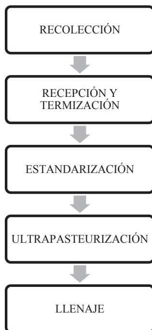
Figura 2.4 Etapas del proceso de producción
