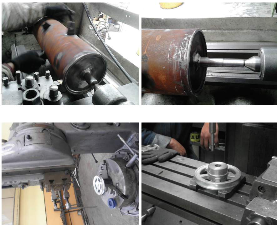
Figura F.3: Maquinado del Cilindro Trillador y Poleas
