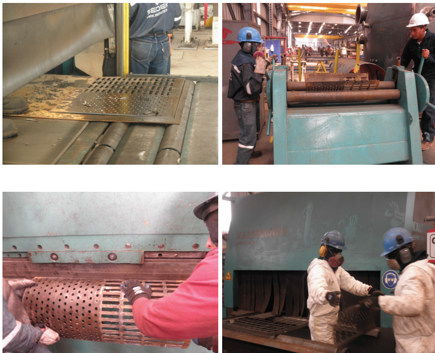
Figura F.5: Corte, Rolado y Doblado del Cóncavo o Tamiz
