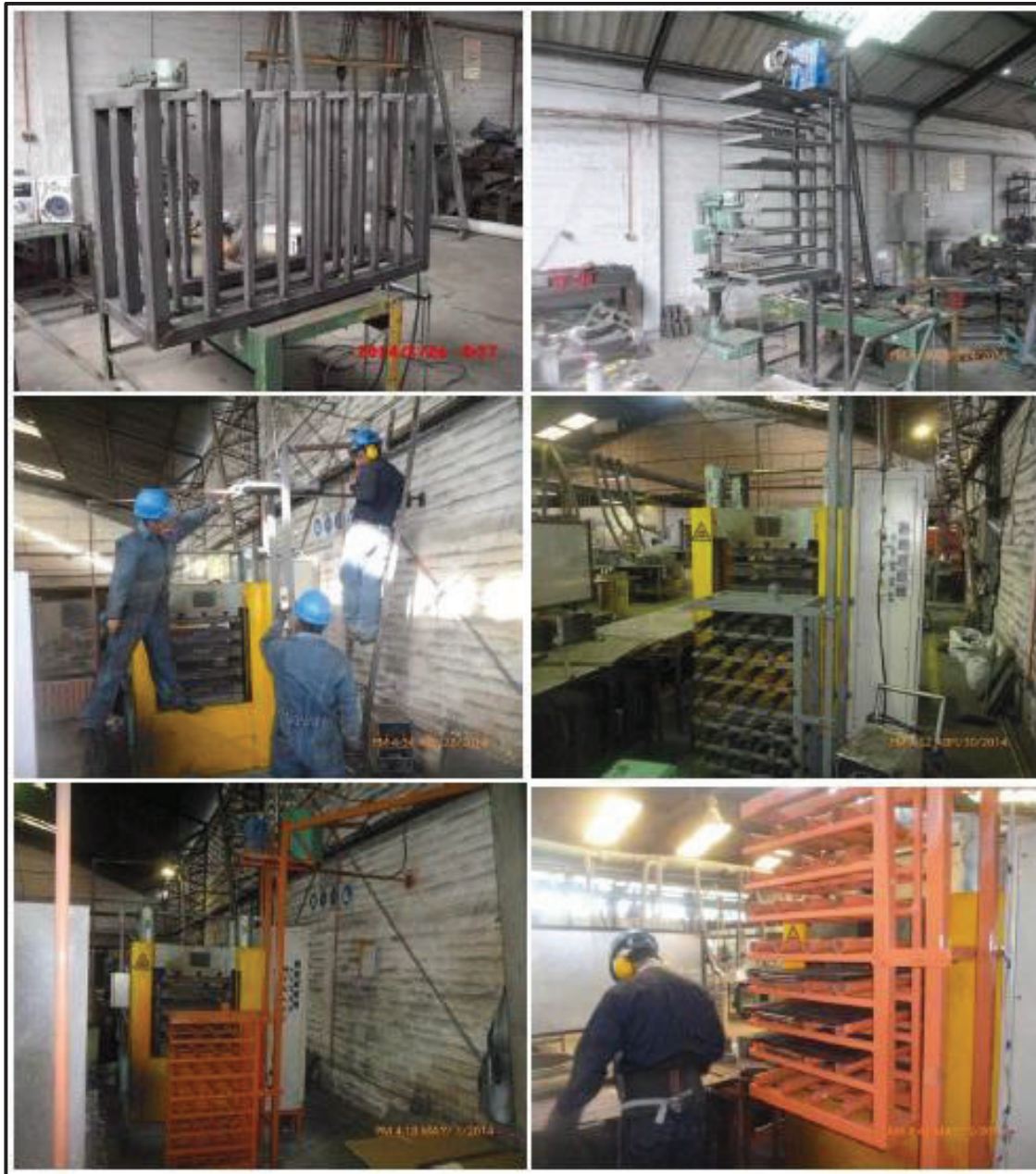
Figura 3.7. Construcción y montaje elevador de matrices en PPP1
