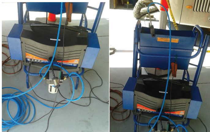
Figura 3.11. Analizador de gases MGT5 y sus accesorios para lectura de gases contaminantes.
