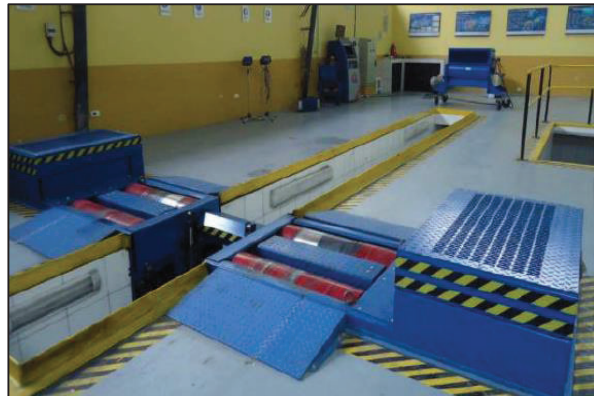
Figura 3.2. Dinamómetro de chasis LPS 3000.
