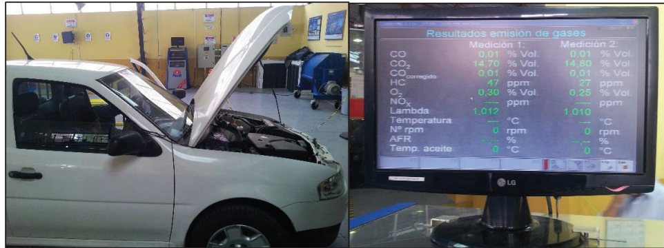
Figura 3.29. Resultado de las pruebas de análisis de gases contaminantes.
