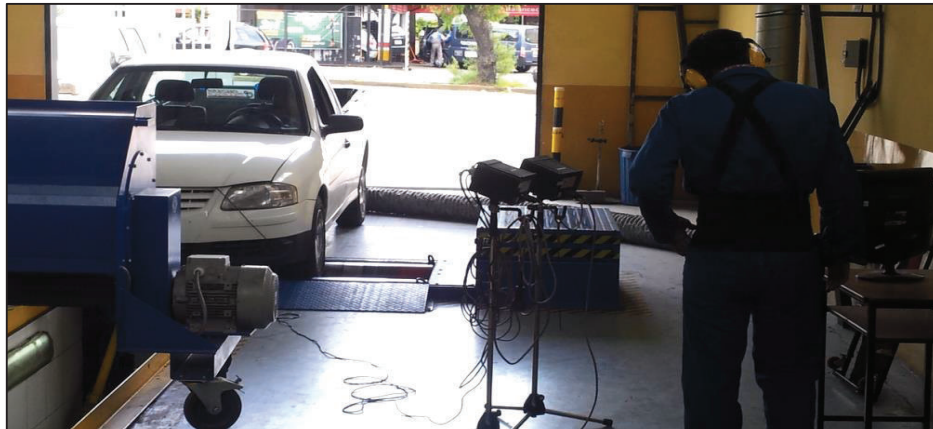
Figura 3.1. Prueba del vehículo en dinamómetro. 18
