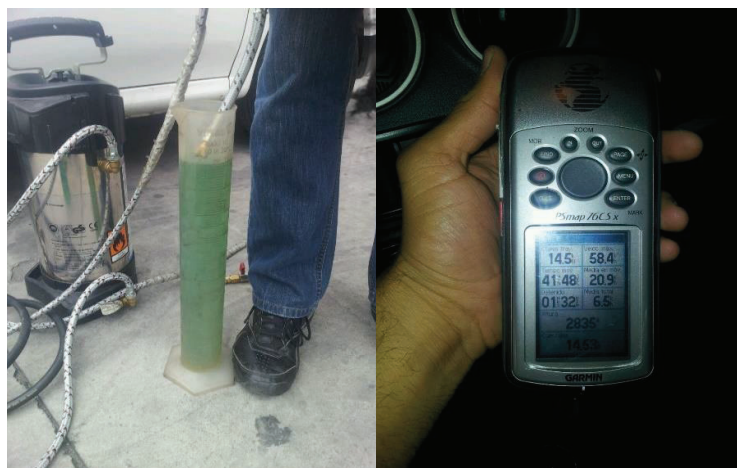
Figura 3.6. Medida final de combustible y datos del recorrido de la prueba, GPS.
