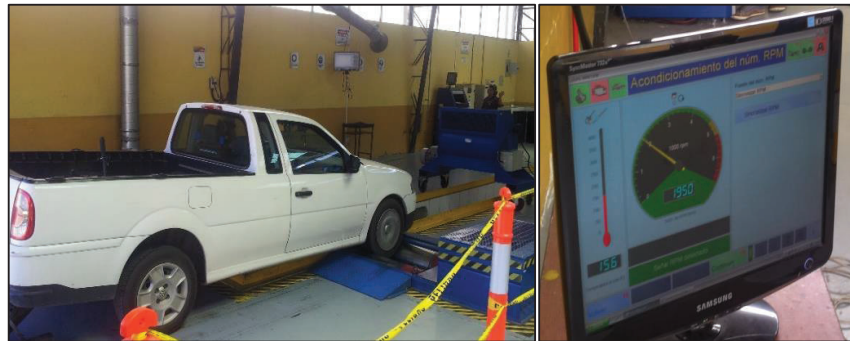
Figura 3.22. Prueba estática de potencia y par motor.
