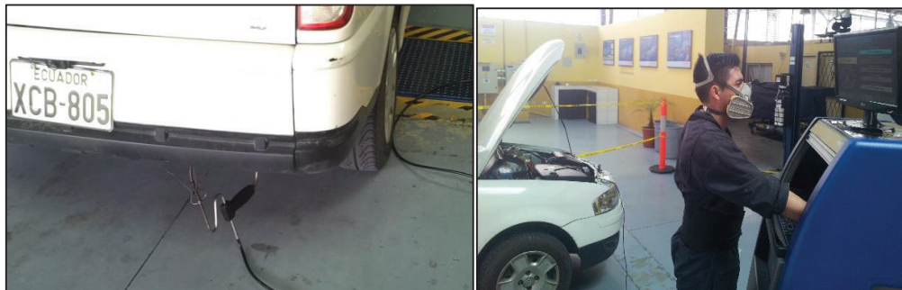
Figura 3.10. Prueba estática de análisis de gases contaminantes.
