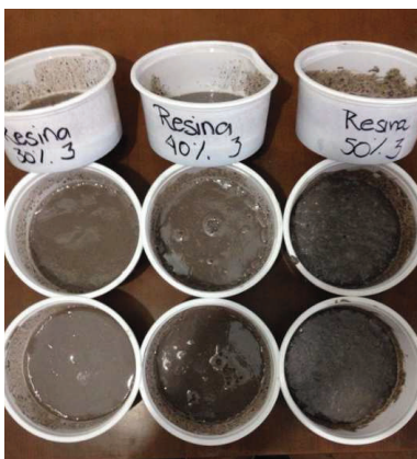
Figura 2. 3 Muestras encapsuladas con resina al 30%, 40% y 50% de relación lodo: encapsulante
