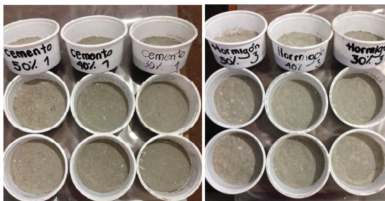
Figura 2. 1 Muestras encapsuladas con cemento y hormigón a 30%, 40% y 50% de relación en peso lodo:encapsulante
