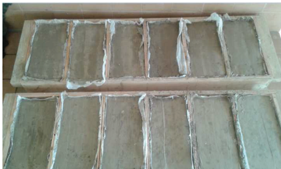
Figura 2. 2 Bloques encapsulados con cemento y hormigón en proceso de curado
