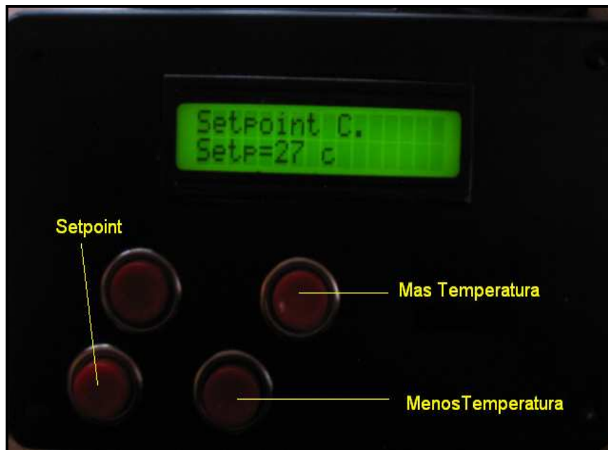
Fotografía 3.2. Pulsadores de Seteo
