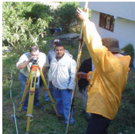
Figura 2.19 – Medición de Altura con el Método Nivel de Ingeniero (CEDECAP, 2008)
