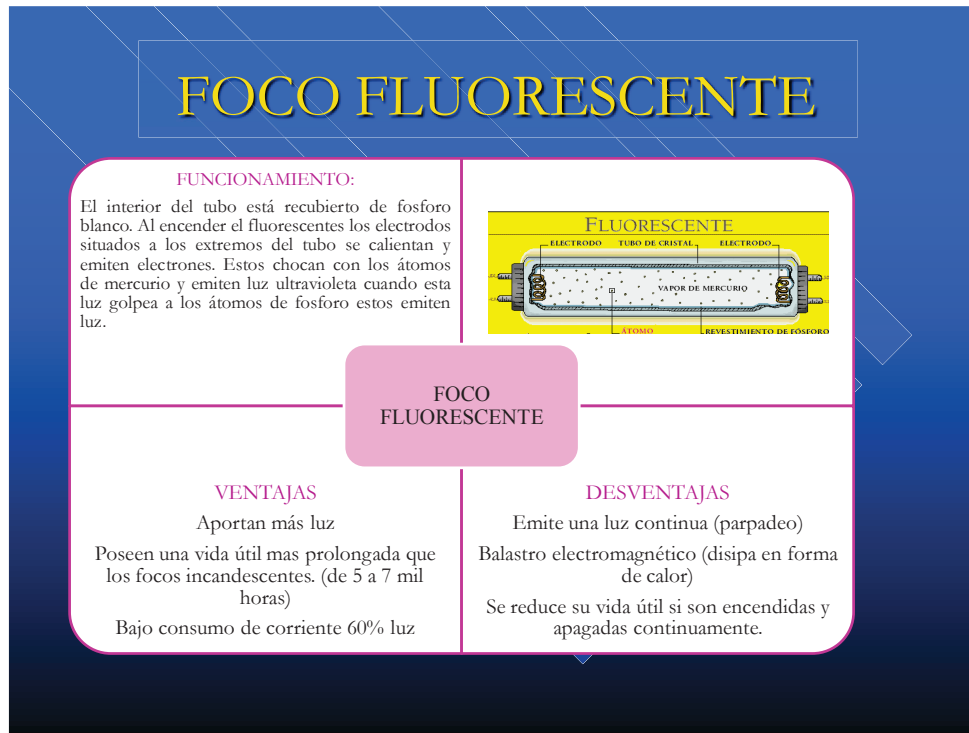
Figura 0.2 – Características de un Foco Fluorescente (Realizado por el Autor)
