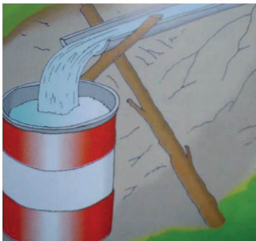
Figura 2.21 – Medición de caudal con el método del recipiente (CEDECAP, 2008)
