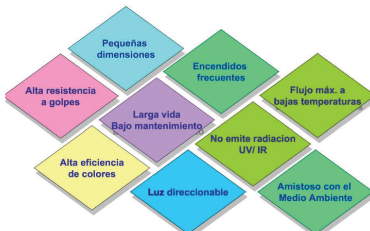
Figura 0.5 – Ventajas de la Tecnología LED, frente a las fuentes de luz convencionales (Ohmios, 2013) Recuperado de: http://ohmios.es/2013/04/23/iluminacion-de-estado-solido-led-una-aproximacion-a-su-conocimiento-capitulo-i/
