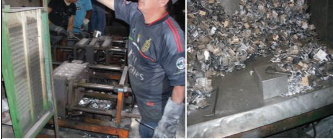
Figura 4.59: Coquillas (Izq.) mesa para retiro de bebederos (der.) (Fundidora 7)
