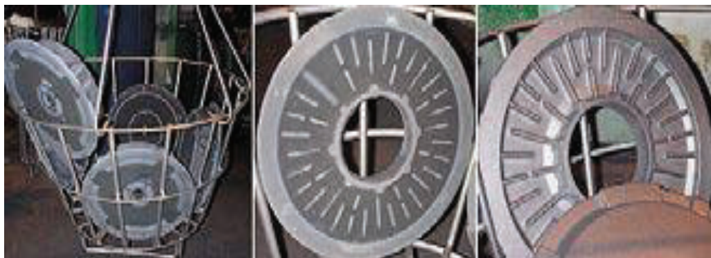
Figura 2.18: Piezas antes (izq., centro) y después (der.) del granallado con arena (Bref, 2009, Pág. 81)
