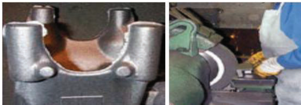
Figura 2.20: Rebabas (izq.) y amolado (der.)
