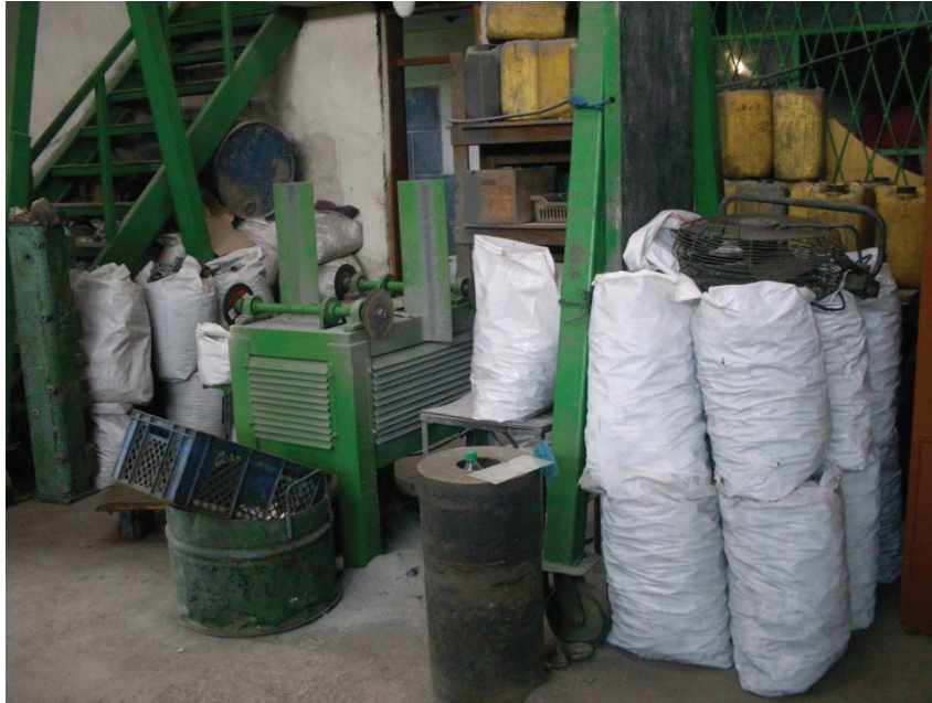
Figura 4.56: Máquina para pulir y costales de polvo de aluminio (Fundidora 7)
