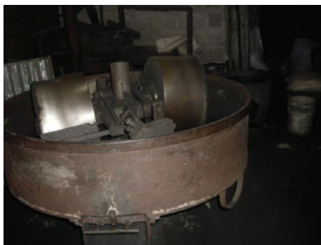
Figura 4.9: Maquina de mezclado de arena
