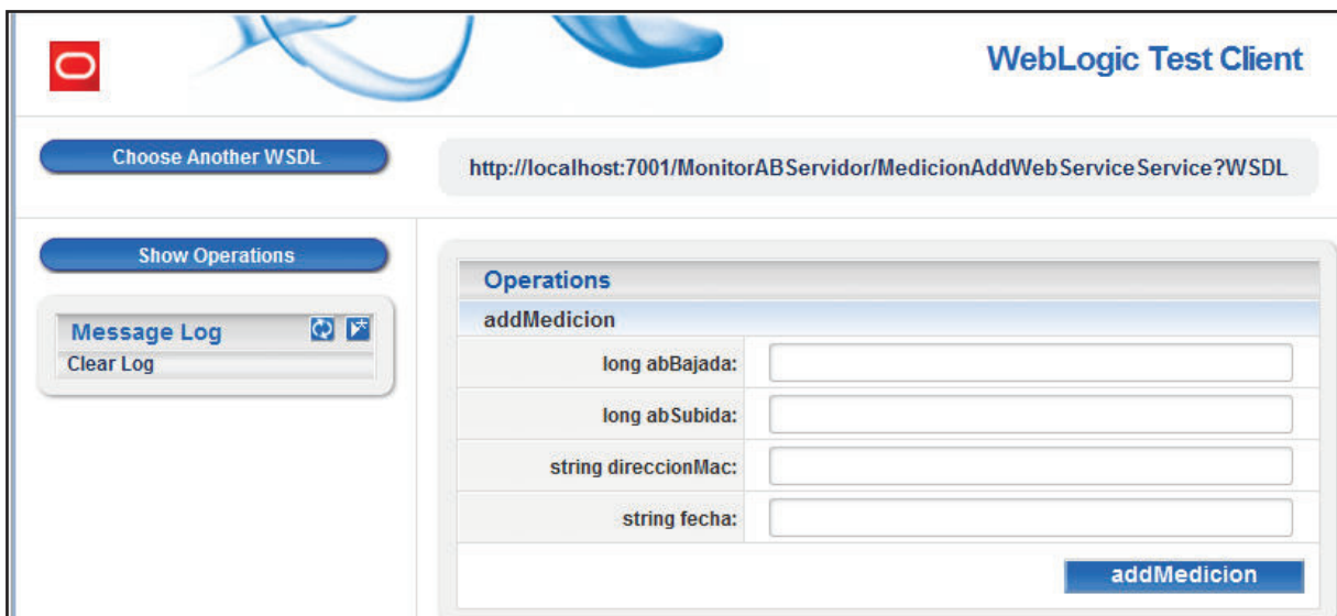
Figura 4.14. Prueba de funcionamiento de la publicación del servicio web para la recepción de mediciones.
