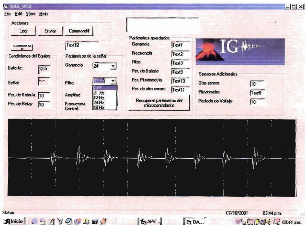
Fig. No. 5.3.- Ventana que despliega el programa DAS_VCO, donde se observa los posibles valores del filtro
