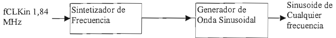
Fig. No. 2.24 Diagrama del Generador de Onda Sinusoidal
