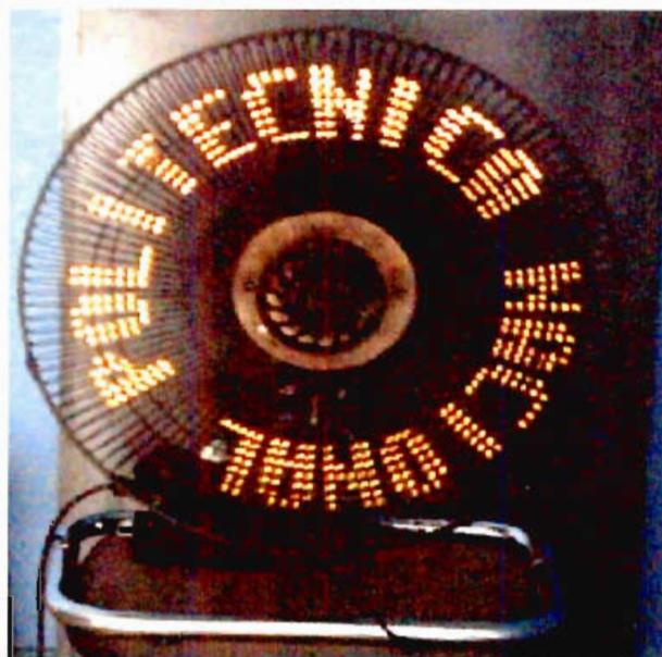
*Figura 4.16. Generador de caracteres con LEDs de color amarillo*
