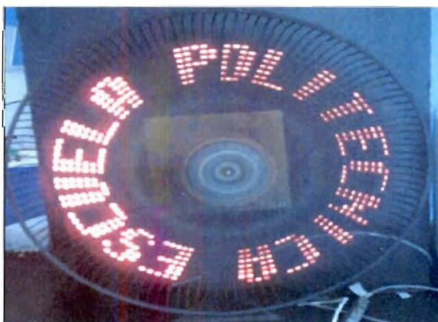
Figura 4.2. Generador de caracteres con 3 grados de separación (20 caracteres).
