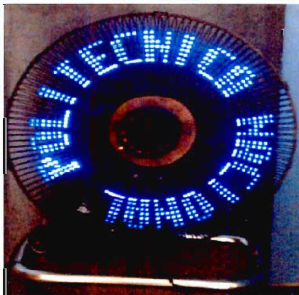
*Figura 4.17. Generador de caracteres con LEDs de color azul*
