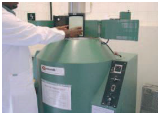
Figura 1.1. Irradiador gamma auto contenido de almacenamiento en seco (IAEA, 2005, p.19)
