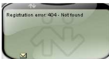
Figura 3-29 Falla en el registro de la extensión
