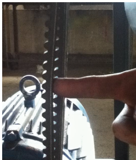
Figura 4.12. Tensión inicial de las bandas.
