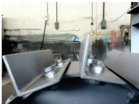
Figura 4.7. Aumento de arandelas para el balanceo.
