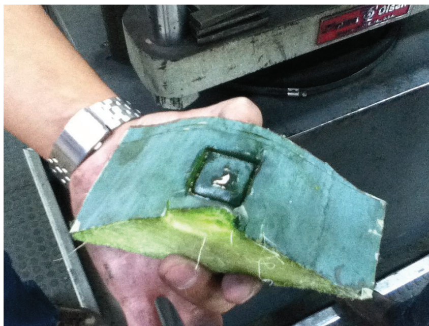
Figura I.2. Aspecto de hoja después de compresión.
