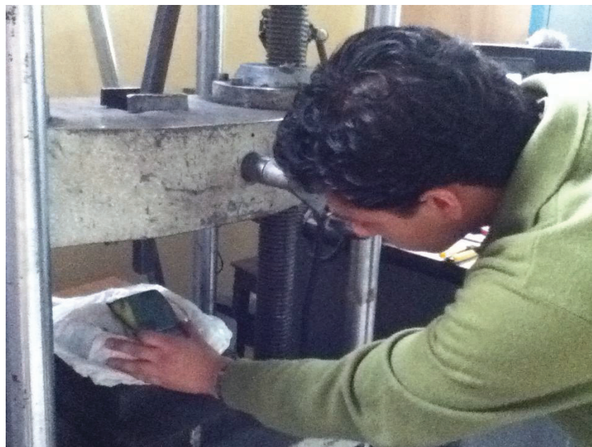
Figura I.1. Ubicación de hoja para compresión con tubo cuadrado.
