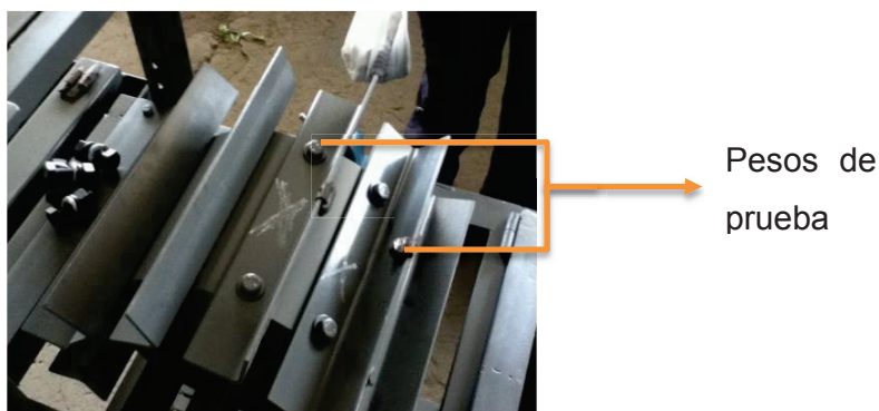
Figura 4.6. Perfiles donde se requiere aumentar peso.
