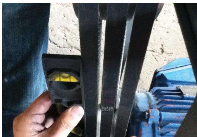
Figura 4.11. Alineación de las bandas.
