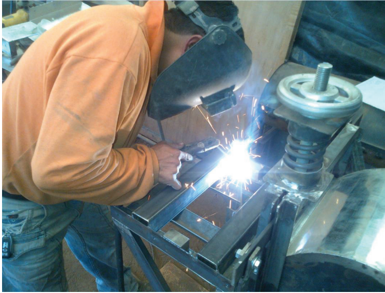
Figura N.3. Proceso de soldadura para la mesa.
