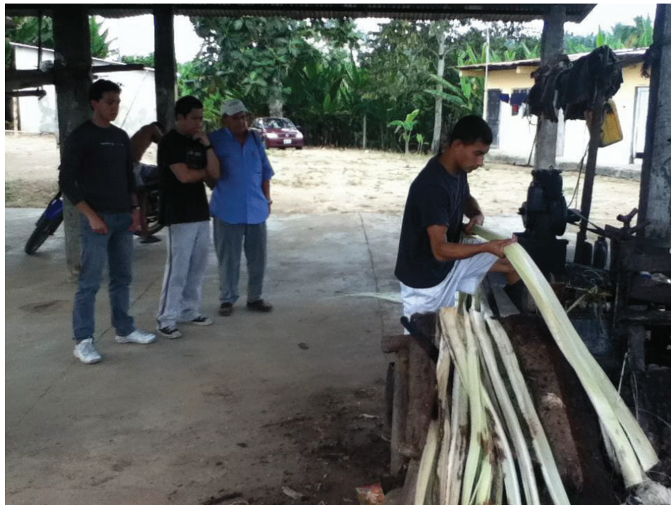
Figura O.2. Desfibrado de abacá (Método de Hagotán).
