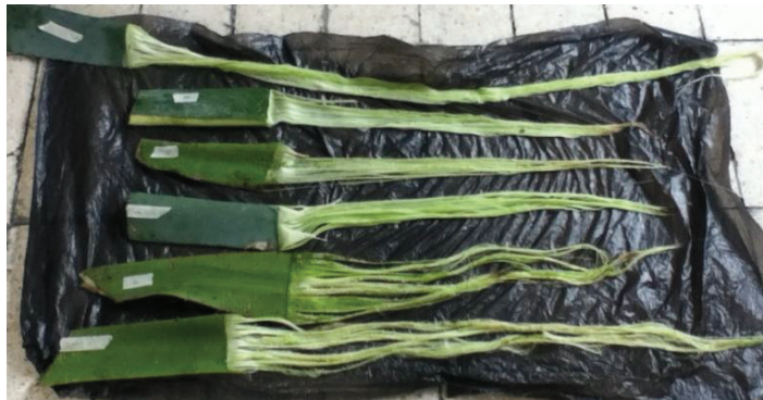
Figura 2.7. Muestras de calidad de fibra obtenida mediante el desfibrado en la descortezadora.
