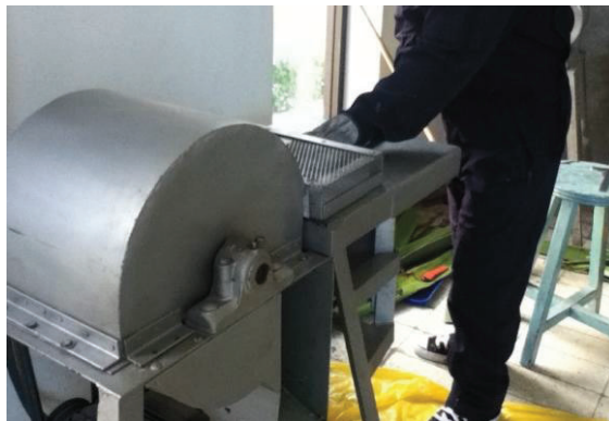
Figura 2.6. Ensayo de desfibrado de cabuya (agave americana y furcraesa andina).
