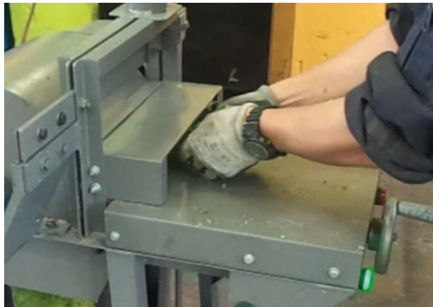
Figura 4.27. Introducción de hoja de cabuya al rotor.
