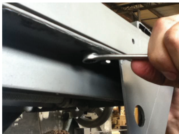
Figura 4.5. Ajuste de la mesa.
