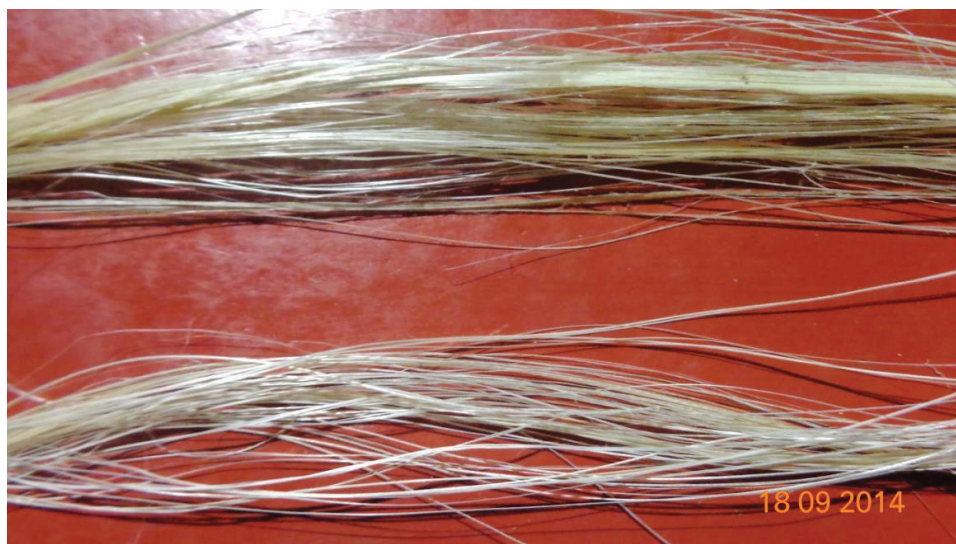
Figura 4.21. Fibra obtenida por desfibrado con rotor (superior) y fibra obtenida por cuchillas (inferior).
