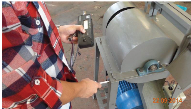
Figura 4.24. Mapeo de estructura con medidor PROVIBTECH PT908.
