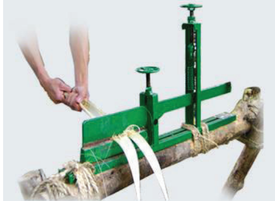
Figura 1.18. Descortezadora manual Kolbi para pseudotallos.
