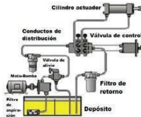
Figura 2. 4 Esquema de un sistema hidráulico
