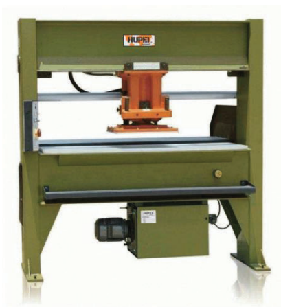
Figura 1. 10. Troqueladora Ch-858 con cabeza de corte hidráulica
