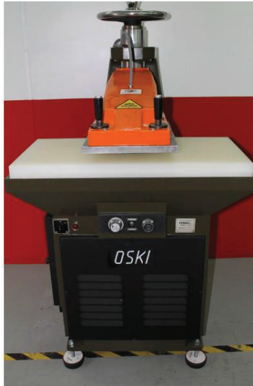
Figura 1. 7. Troqueladora con PMI cercano al punto de aplicación
