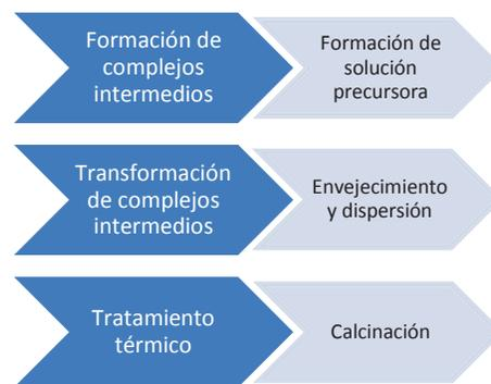
**Figura 1.4.** Mecanismo del proceso de precipitación controlada
