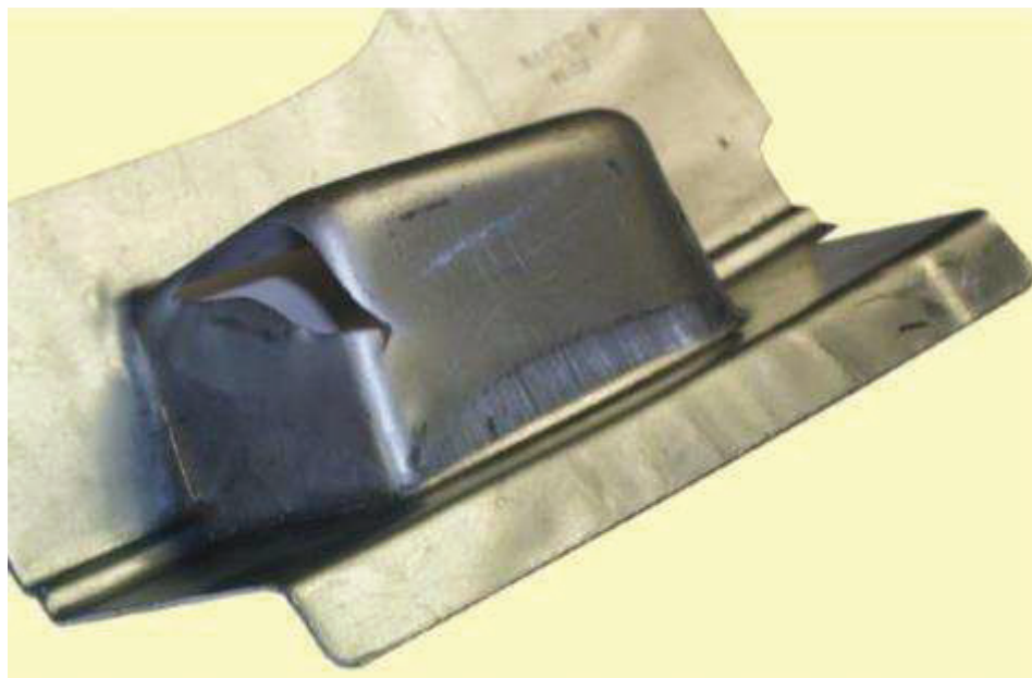
Figura 2.6 - Rotura de una pieza automotriz
