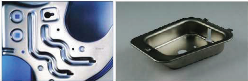
Figura 1.14- Diferencia entre una parte estampada y una embutida, la altura de la saliente o deformación es mucho menor en la parte estampada.
