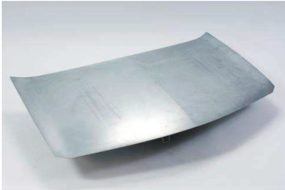
Figura 2.5 - Capó fabricado en acero IF220
