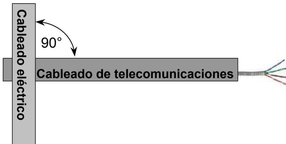
Cuando se utilicen canaletas (estructuras rígidas), el cable de telecomunicaciones deberá ir en compartimiento separado al cableado eléctrico
