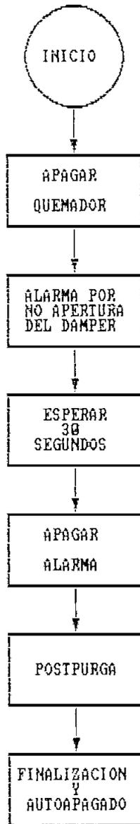
FIGURA N<sup>o</sup> 3.18 Diagrama de flujo de alarma por no apertura del damper
