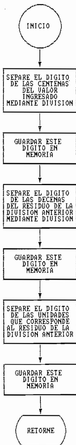
FIGURA Nº 3.21 Diagrama de flujo de la subrutina de transformación del dato a código BCD
