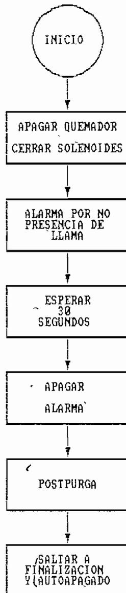
FIGURA Nº 3.20 Diagrama de flujo de alarma por no presencia de llama
