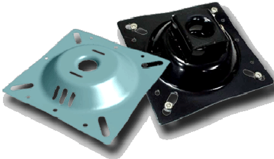
Figura 3.1 Chapas metálicas embutidas con agujeros simulación con el programa Stampack.
