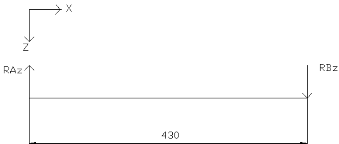
Figura 4.11. Fuerzas que actúan en el eje en el plano Y – X
