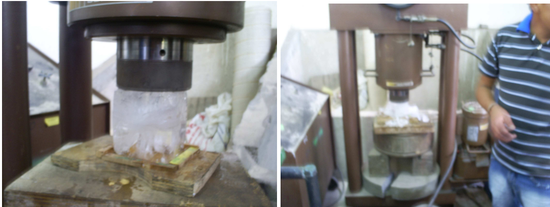
a) Colocación de la probeta de hielo en la máquina universal.
