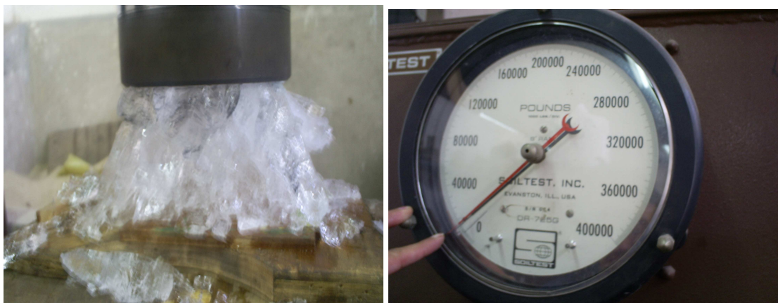
a) Probeta de hielo después del ensayo de compresión. b) Registro de la fuerza de compresión.
