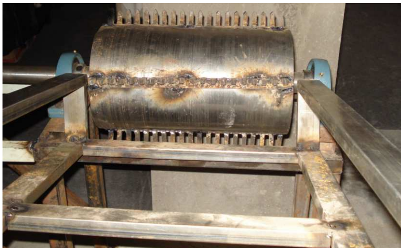
Figura 4.4. Disposición de las cuchillas.
