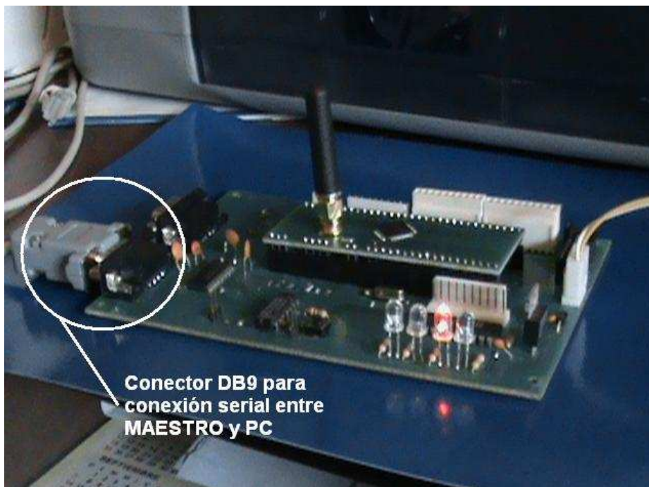
Figura 5.3 Conexión del puerto serial del MAESTRO al PC
