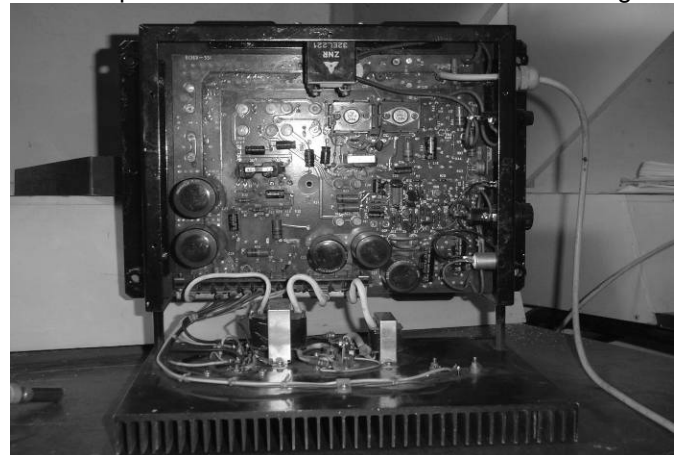
Figura 5 Acondicionamiento didáctico del modelo 63834A marca NEC de procedencia japonesa Para comprobar el funcionamiento de ambos prototipos de convertidores bajo régimen de carga, fue necesaria la construcción de un módulo de carga resistiva variable
