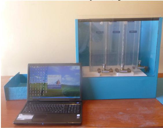
Figura 4. Modulo de Tanques Acoplados
