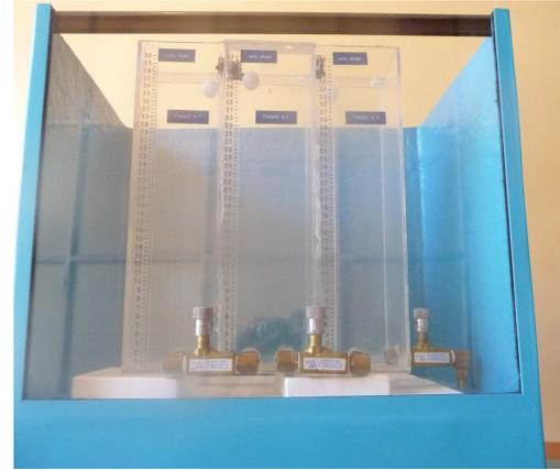
Figura 6. Tanques Acoplados
