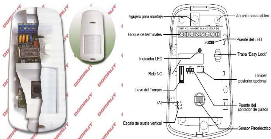
Figura 2.12: Detector de movimiento para la red de seguridad 18
