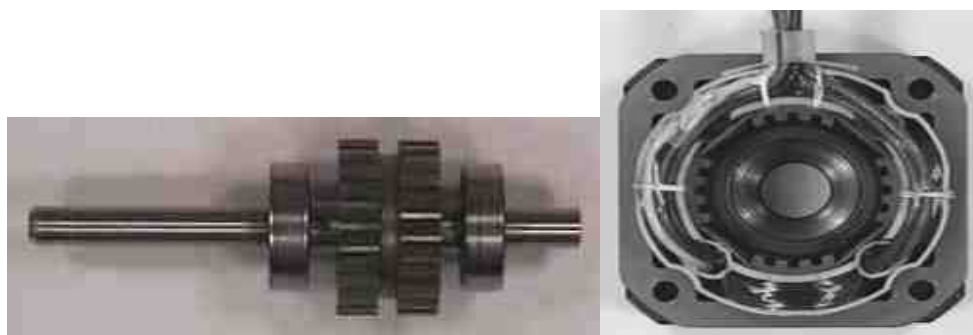
Figura 2.8: Rotor y Estator de 4 bobinas de un motor paso a paso 13
