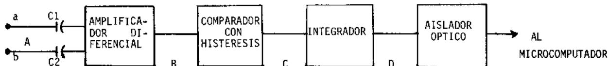
Fig. 2.- Dispositivo Sensor de Tonos
