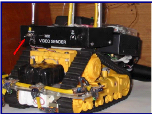
Figura 1.2 Ubicación del interruptor #0 de encendido del transmisor
