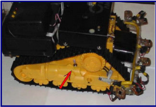
Figura 1.1 Ubicación del interruptor principal #1
