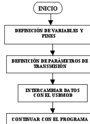
Figura 17. Algoritmo de la Comunicación Serial USB
