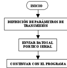
Figura 16. Algoritmo de la Comunicación Serial RS-232
