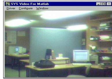
Figura 5. Toolbox VFM ( Visión for Matlab ) desarrollado por Farzad Pezeshkpour permite importar la imagen hacia una ventana en Matlab y obtenerla en formato Binario.
