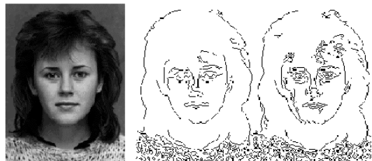
Figura 2. Detección de Bordes con el método Canny
