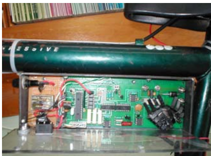
Figura 7 Sistema de Control y Potencia
