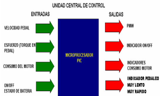
Figura 5 Esquema electrónico básico del Sistema Motriz para Bicicletas
