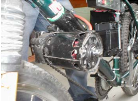
Figura 6 Motor DC montado en el cuadro de la bicicleta
