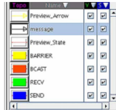
Fig. 11. Leyenda que indica el tipo de llamada a MPI la cual se identifica por un color específico. En las siguientes figuras se utiliza la simbología para message, BARRIER, BCAST, RECV y SEND; y no se utilizan Preview_Arrow y Preview_State. BARRIER muestra el tiempo que toma una llamada a MPI_Barrier, BCAST muestra el tiempo que toma una llamada a MPI_Bcast, RECV presenta el tiempo que tarda realizar una llamada a MPI_Recv y SEND indica el tiempo de la llamada MPI_Send.
