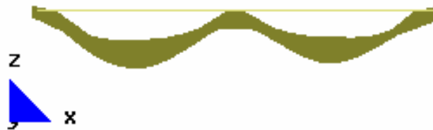
Fig. 3.43 Desplazamientos y deformaciones en la placa CD2.
