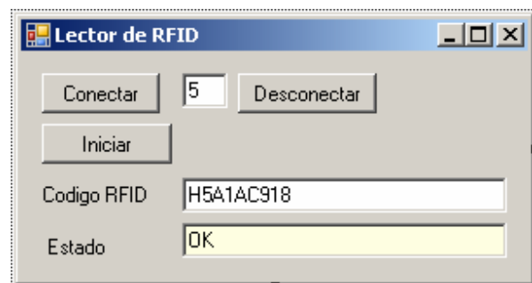
Fig. 6. Aplicación Windows para adquisición del código desde el lector serial RFID
