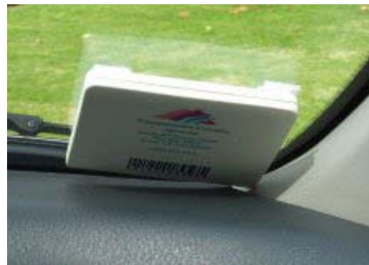
Fig. 5. TAG RFID dentro de un vehículo
