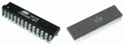
Figura 5. Atmega 8 y Atmega 32 respectivamente
