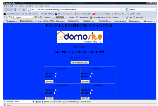
Figura 8 c) Pantalla principal de sistema de control domótico.
