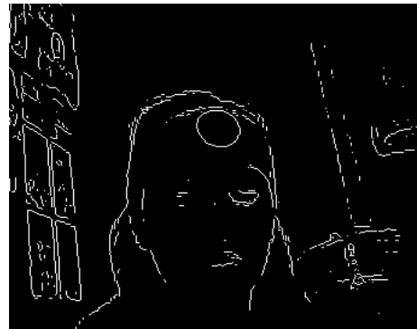
Figura12. Detección de bordes mediante algoritmo de PREWIT
