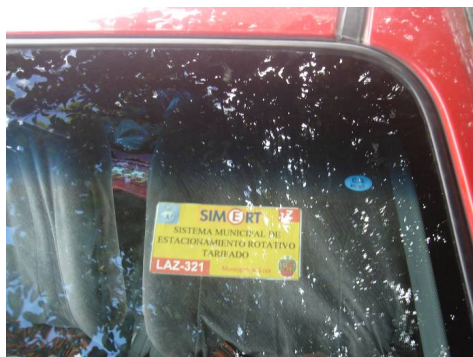
Figura 5. Ubicación de TAGs EPC INT TAG SIMERT de Intermec en el vehículo
