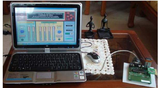
Figura 7 Módulo Coordinador conectado al Computador
